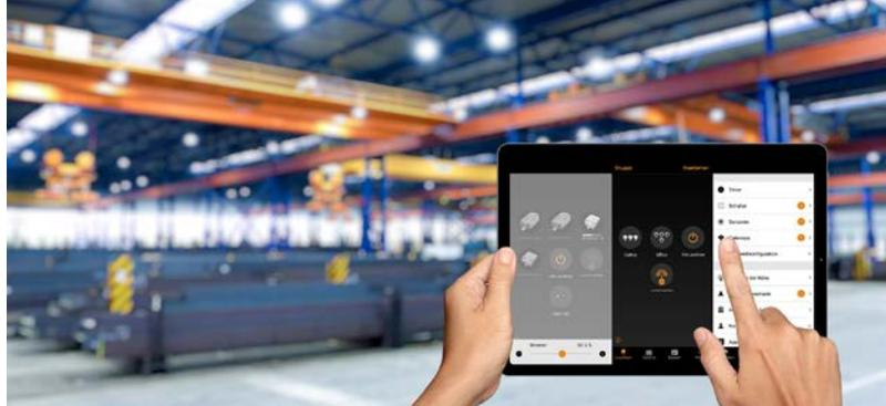
*Abb.: Die Konfiguration von Lichtmanagementsystemen kann mittels kostenloser App erfolgen. Eine Kalenderfunktion ermöglicht die Einrichtung von tages- und wochentagspezifischen Szenen.*
