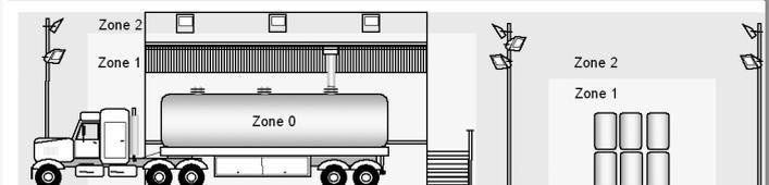
Bild 2: Abfüllen und Lagern von brennbaren Flüssigkeiten
