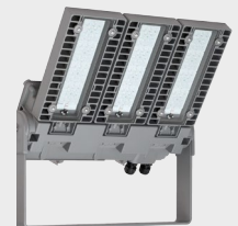
Bild 5: Explosionsschutz Leuchte e8820 für staubgefährdete Bereiche der Zone 21 in der Zündschutzart: Schutz durch Gehäuse „t“
