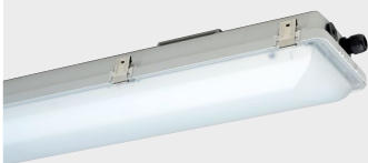
Bild 3: Explosionsgeschützte Leuchte e865 für staubgefährdete Bereiche der Zone 21 in der Zündschutzart: Schutz durch Gehäuse „t“
