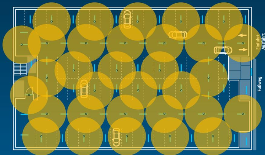
Die SENS-Leuchten sind direkt über der Fahrbahn, über den Parkbuchten sowie am Treppenzugang platziert, um eine möglichst breite Abdeckung der Flächen zu erreichen.
