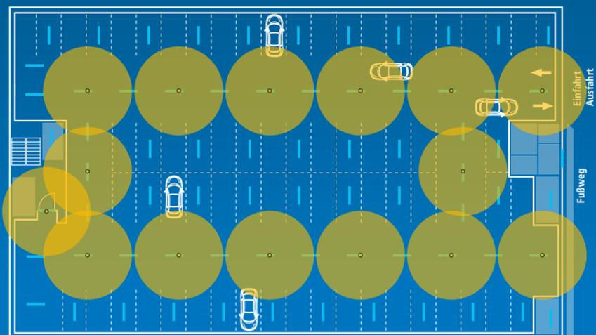
Die SENS-Leuchten sind direkt über der Fahrbahn sowie am Treppenzugang platziert. Die Parkbuchten selbst werden nicht durch Sensoren erfasst.
